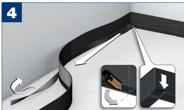
Après avoir achevé la pose de l'isolant sur toute la surface à réaliser, commencer la pose de FASSA SILENS GP 1, joint périphérique de désolidarisation préformé en «L». Enlever uniquement la bande adhésive placée sur le côté court (partie inférieure) et le coller, tout le long du périmètre, sur les panneaux FASSA SILENS SLE 23, en veillant à réaliser un pli à 90°.
