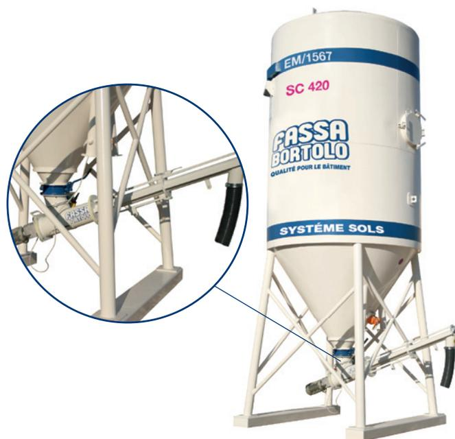
VIS SANS FIN D'EXTRACTION L150 : elle permet de charger la pompe pour chapes plus rapidement et de manière plus constante, en assurant par conséquent à la chape une meilleure homogénéité des caractéristiques finales, tout en réduisant l'effort physique de l'opérateur.
