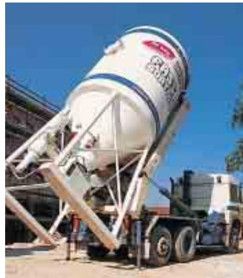
Il massetto **SA 500** viene impastato mediante mescolatore orizzontale FASSA collegato direttamente alla stazione silo ed inviato al punto di posa mediante pompa a vite continua.
